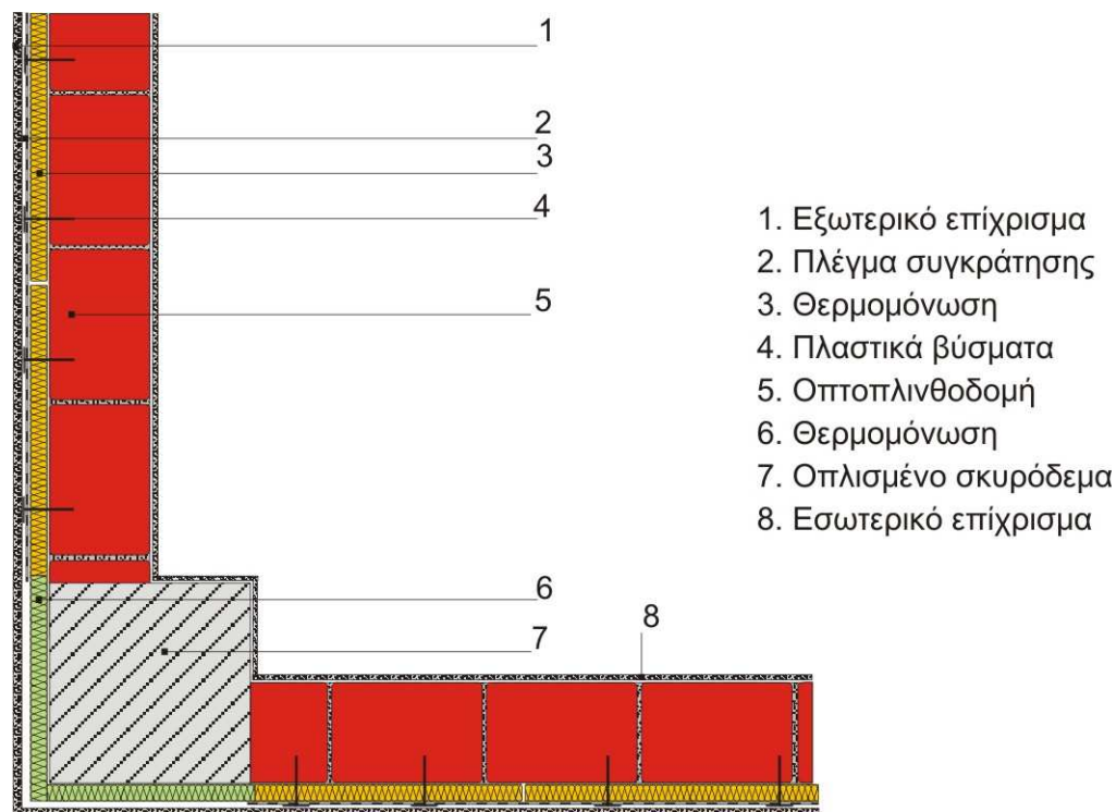
ΣΧΗΜΑ 3.3. ΚΑΤΟΨΗ ΓΩΝΙΑΣ ΤΟΙΧΟΥ – ΤΟΙΧΕΙΟΥ – ΤΟΙΧΟΥ
